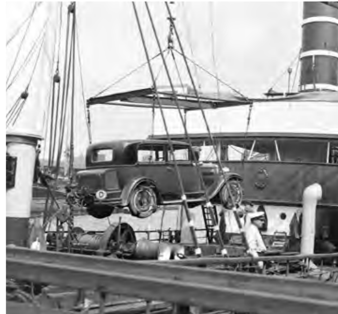
Waren aller Art wurden im Hamburger Hafen umgeschlagen – neben Kaffee und Tee auch Zirkuselefanten und Automobile. Mit einem speziellen Anlegegeschirr wird das Fahrzeug sicher an Bord des Frachters gehievt. Der Kran stammt vom Hamburger Hersteller Nagel & Kamp / Kampnagel.
